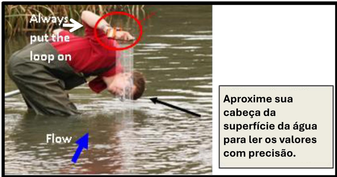
Figure 2-2. Figura 2-2. Observando a altura máxima da água na haste transparente de cabeça de velocidade (ou 'prancha de velocidade').
